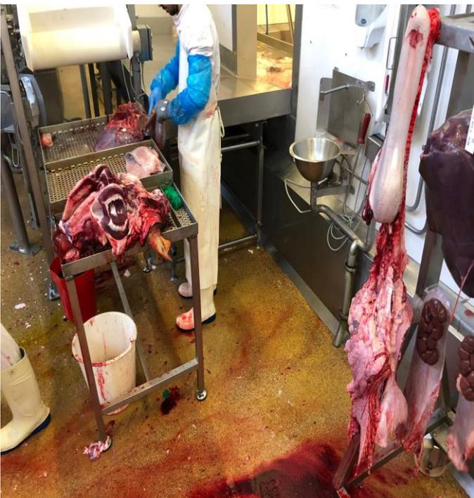
**Système d'accrochage des fressures trop bas pour l'inspection des NL.**
