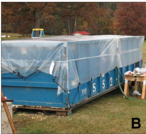
Illustration 8 : Adaptation de caisson standard et construction d'enceinte pour le gazage des porcs (Meyer, 2014)
